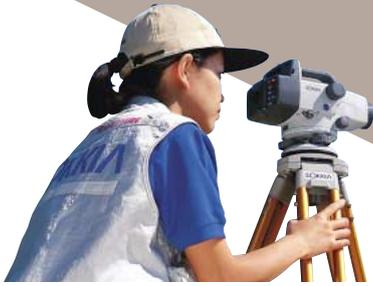
POWERLEVEL SDL30—それは、ソキアが抱きつづけてきた水準測量の理想を形にした1台だ。測定者はスタッフに望遠鏡を向けてピントを合わせるだけ。ボタンひとつで、SDL30が標尺の高さと標尺までの距離を自動測定し、デジタル表示する。その操作性・信頼性・機動性は、水準測量の新しい可能性を見せてくれるはずだ。さあ、SDL30と出かけよう、もっとパワフルな水準測量へ。
