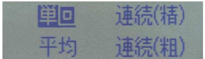
SDL30には、目的に応じて、精密単回、連続(精)、平均、連続(粗)の4種類の測定モードが選択可能。
